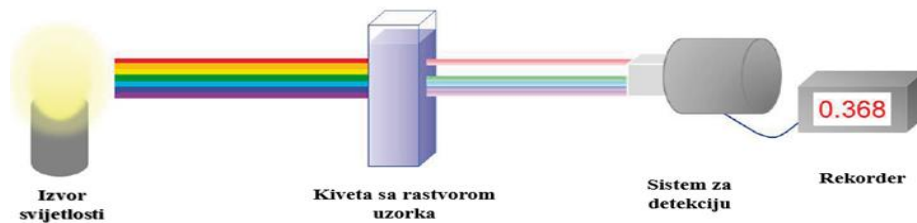
Slika 20. Šema UV-VIS spektrofotometra (Cosimo i Haller, 2015).
